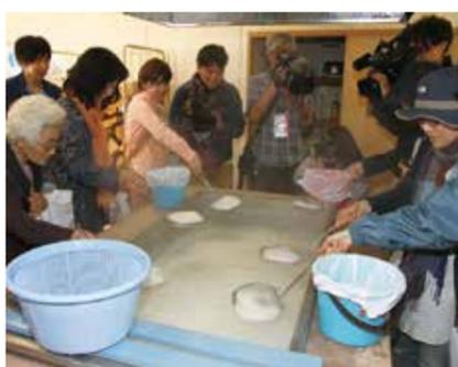
釜から塩をすくい上げ、脱水、乾燥し完成
