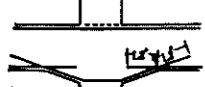
1) 最上層・一般層の連続梁 (ハンチのある場合) 注「鉄筋コンクリート造配筋指針別冊」による
