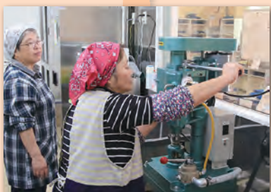
真空巻締めをし、圧力釜で90分
