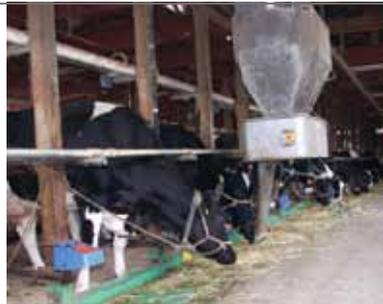
牧原牧場では、1日5回の給餌を機械が自動で行う。計画的な機械化で楽な作業を目指す
